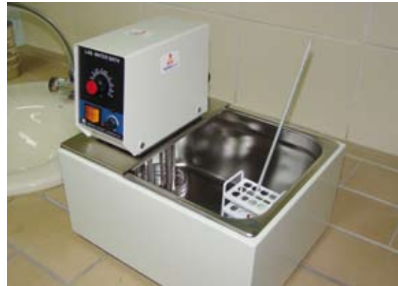
Baño María. Es utilizado fundamentalmente para llevar a temperatura de trabajo muestras congeladas.
