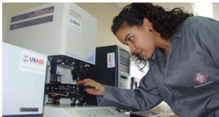
Ir Prestige AIM8800. Permite la identificación de sustancias de naturaleza orgánica
