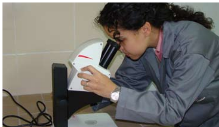
Microscopio Estereoscopio. Permite la observación microscópica de objetos, de manera tridimensional.
